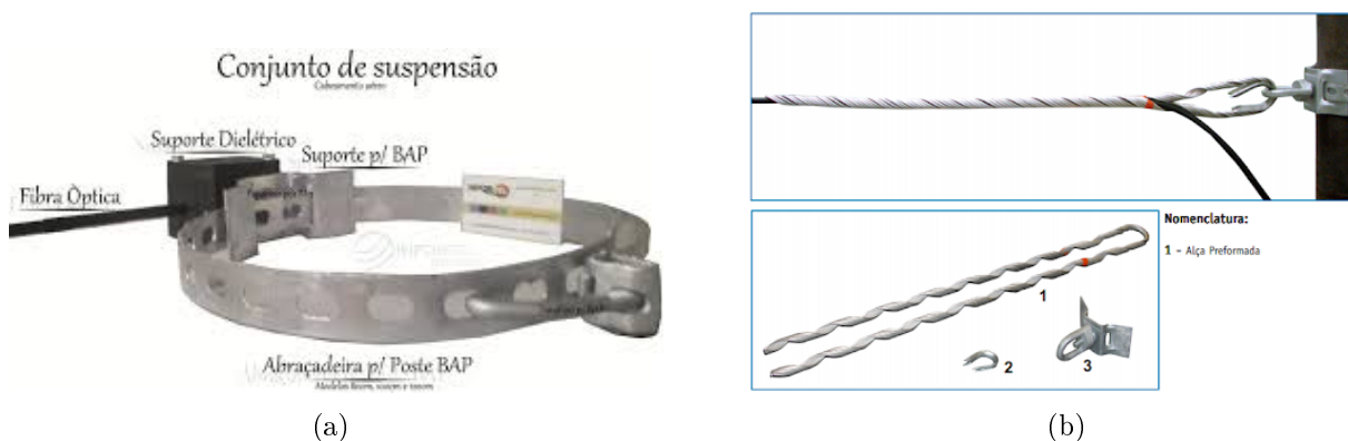
Figura 6.5: (a) Exemplo de conjunto de sustentação de cabo óptico para estrutura tangente. (b) Exemplo de conjunto de ancoragem para cabo óptico.
